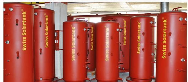
Jenni Energietechnik AG stellt Energiespeicher in allen Grössen her. Dabei erhalten die grossen Energiespeicher immer mehr Bedeutung. Zeitweise verlassen wöchentlich mehrere Speicher mit 50'000 bis 200'000 Liter Inhalt die Produktionsstätte im Emmental. Rund die Hälfte der Tanks werden für Holz befeuerte Nahwärmeverbünde eingesetzt. Die übrigen Energiespeicher werden etwa zu gleichen Teilen für die Nutzung von Industrieabwärme und für mehrheitlich solar beheizte Wohnbauten verwendet.
